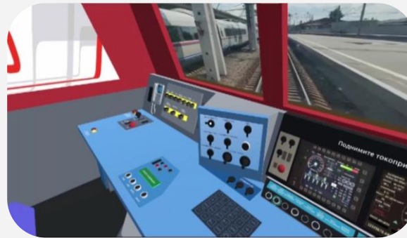
VR-симулятор кабины машиниста электропоезда для РЖД
